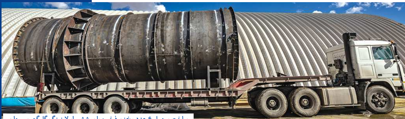
ساخت و حمل ۶ عدد مخزن ذخیره با پوشش رابرلاینینگ گل‌گهر سیرجان
