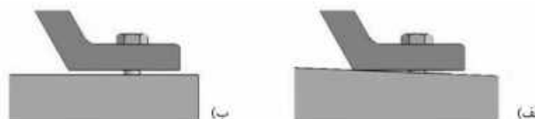
شکل ۳- پایه خم شده- راه حل: استفاده از شیم در پایه C و بررسی مجدد تمامی پایه ها
